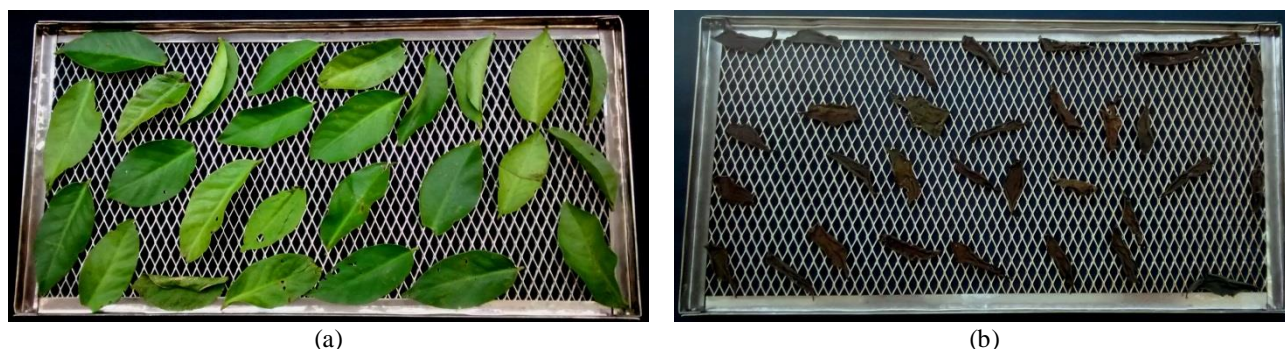
Figura 2 – FOPN após processo de secagem convectiva por 4 horas, nas temperaturas de 40 (a) e 60 °C (b).
