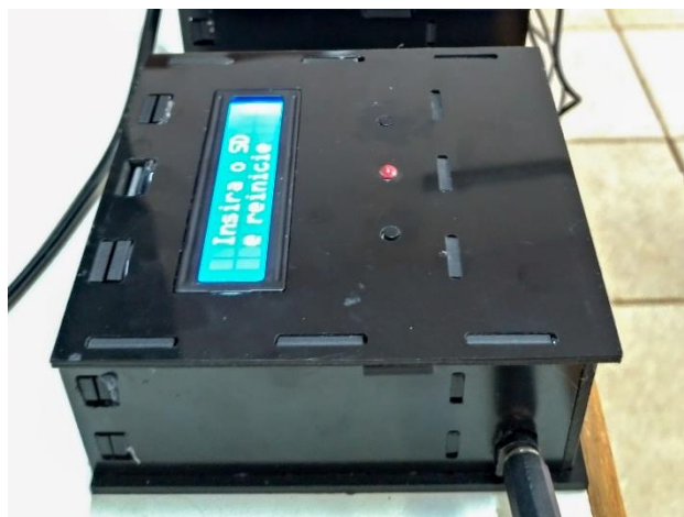
Figura 2 – Versão final do termo-higrômetro
