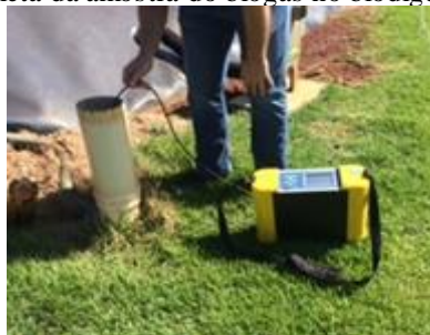
Figura 2 – Coleta da amostra do biogás no biodigestor
